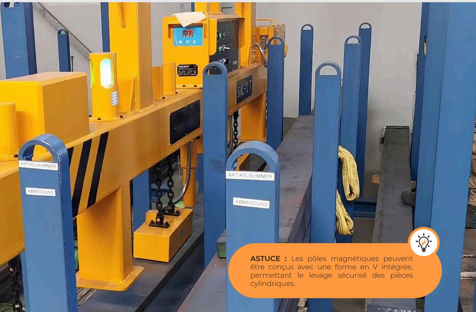
**ASTUCE :** Les pôles magnétiques peuvent être conçus avec une forme en V intégrée, permettant le levage sécurisé des pièces cylindriques.
